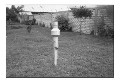
Gambar 2. Alat pengukur curah hujan
